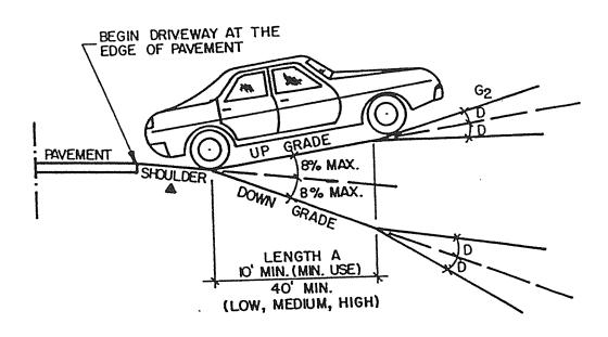
THE SHOULDER SLOPE USUALLY VARIES FROM 1/2"/FT (4%) TO 3/4"/FT (6%). HOWEVER, THE SHOULDER SLOPE SHOULD BE MAINTAINED WHEN CONSTRUCTING THE DRIVEWAY.
